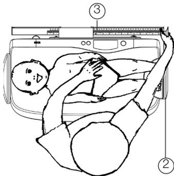
2. Χρησιμοποιήστε το δεξί σας χέρι για να σύρετε το στήριγμα ποδιών (2) προς τη φορά των ποδιών του βρέφους, ενώ τοποθετείτε τα πόδια του βρέφους πάνω στο στήριγμα ποδιών. Με το αριστερό σας χέρι σταθεροποιήστε το βρέφος πάνω στη λεκάνη της ζυγαριάς για βρέφη.
