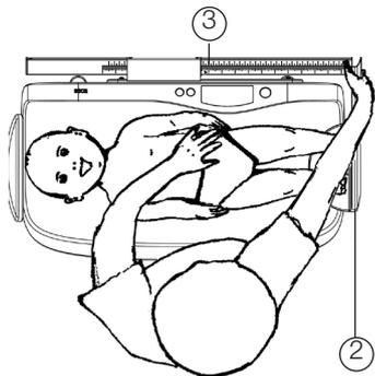
2. 右手で脚部の支え(2)を乳児の足の方向へスライドさせますが、そのとき乳児の足を脚部の支えの上に置きます。左手で乳児を体重計のくぼみの上に固定します。
