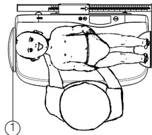
1. Coloque o lactente sobre o tabuleiro da balança. A cabeça do lactente tem de ficar encostada ao encosto para a cabeça (1) do tabuleiro.
