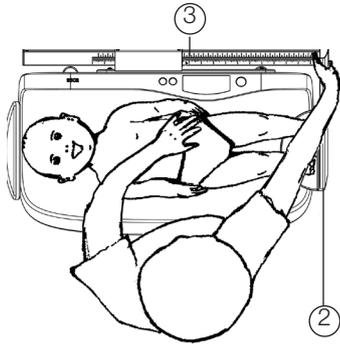
2. Skub med højre hånd fodstøtten (2) i retning mod spædbarnets fødder, og læg derved spædbarnets fødder på fodstøtten. Fiksér spædbarnet med venstre hånd på vægtskålen.
